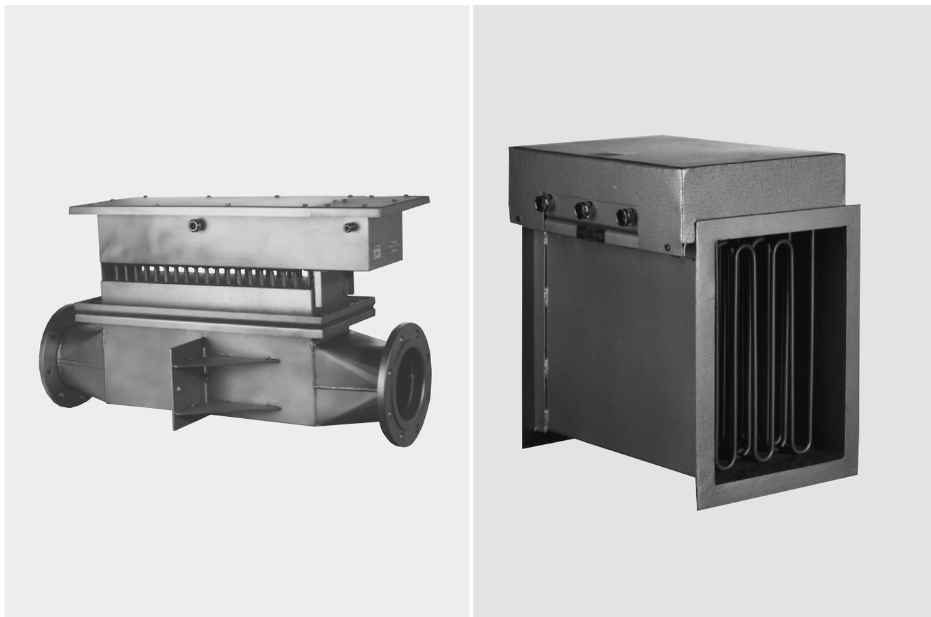
**Anwendung** HELIOS-Gaserhitzer dienen der Erwärmung von nicht-explosiven Gasen z. B. Luft, Wasserdampf, Stickstoff usw. auf max. 700 °C, bis zu 0,3 bar Überdruck. Heizlüfter befinden sich auf der Katalogseite 6.7.
